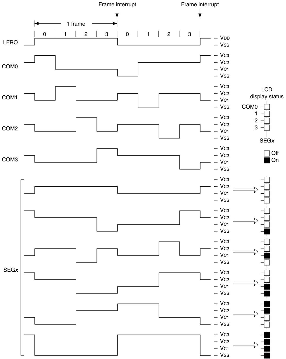
Figure 23.4.2.2 1/4 Duty Drive Waveform
