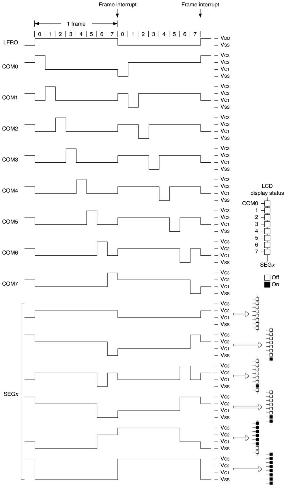
Figure 23.4.2.1 1/8 Duty Drive Waveform
